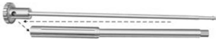
Figura 5 Insertar el mango con rosca
