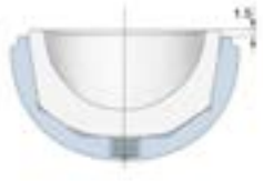
Inserto de X-PE de la talla 39/32 con offset de 1,5 mm sobre el borde del cotilo
